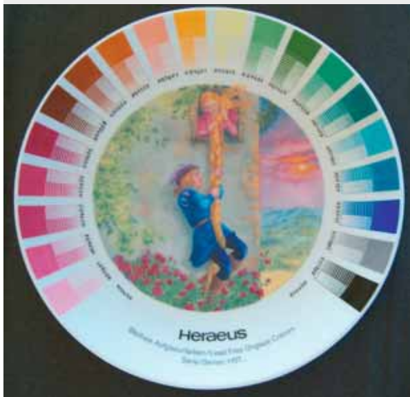
Bild „Prototyp“ des in Arbeit befindlichen Abziehbilds mit Aufglasurfarben der Serie H 57. Auf dem abgebildeten Teller fehlen noch die intensiven Kobaltblautypen.
